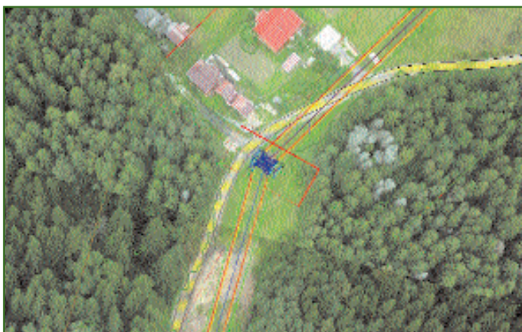
Рис. 1 Фрагмент АРМ КСУПР ФСК ЕЭС участка ЛЭП в виде векторной модели ЛЭП, совмещенной с ортофотомозаикой местности
